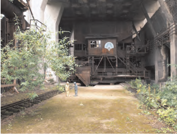
Abb. 11: Stampf- und Stopmaschine im Weltkulturerbe Völklinger Hütte, heute unter dem natürlichen Schutzdach des Betonturms
